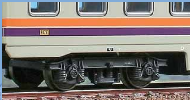
Carrozza FS Tipo 1957R (Corbellini lunga o Corbellona) in livrea grigio ardesia con marcatura unificata e carrelli FS 27. FS car Type 1957R in slate gray livery for local service. FS-Wagen Typ 1957R (langer Corbellini) in schiefergrauer-Lackierung.
